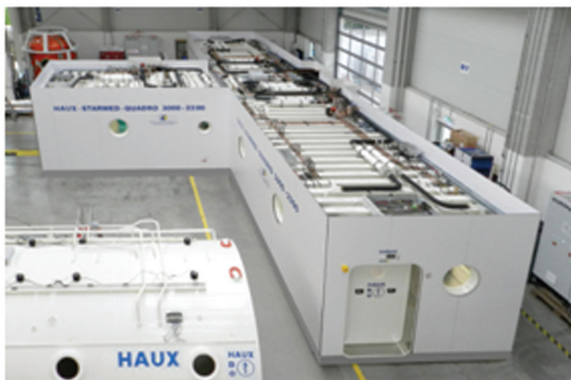
Фото 9. Монтаж барокамеры HAUX-QUADRO-SYSTEM. Университетский госпиталь, Лилль, Франция.
