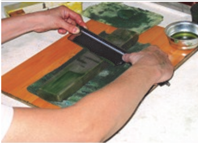
Рис. 10. Заточка микротомного ножа.
